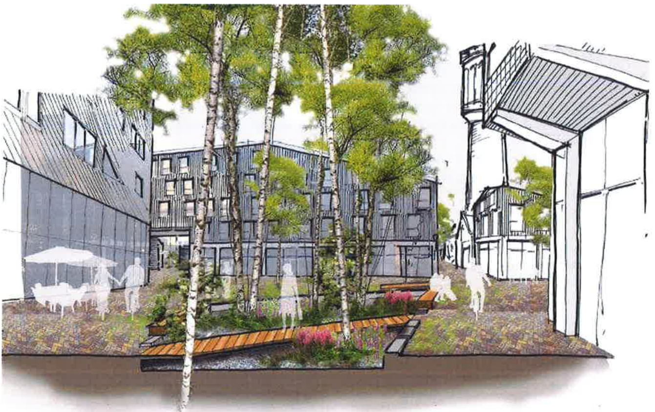
Figuur: Referentie. Voorbeeld van een waterretentie zone. Water kan hier zichtbaar naar toe stromen en worden opgevangen, waarna het rustig kan infiltreren in de grond.
