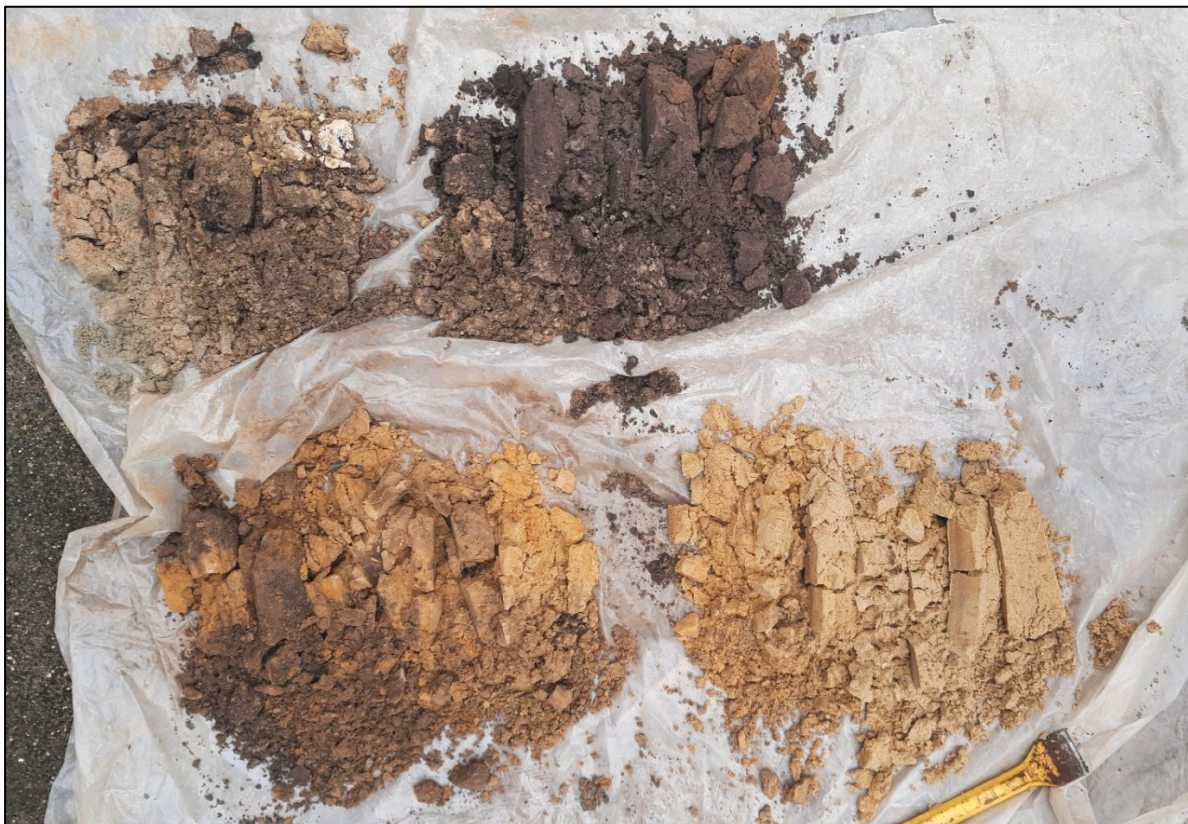
Figuur 8. Boorprofiel van boring 1, leesrichting van linksboven naar rechtsonder (0 – 200 centimeter) (Foto: oktober 2023).
