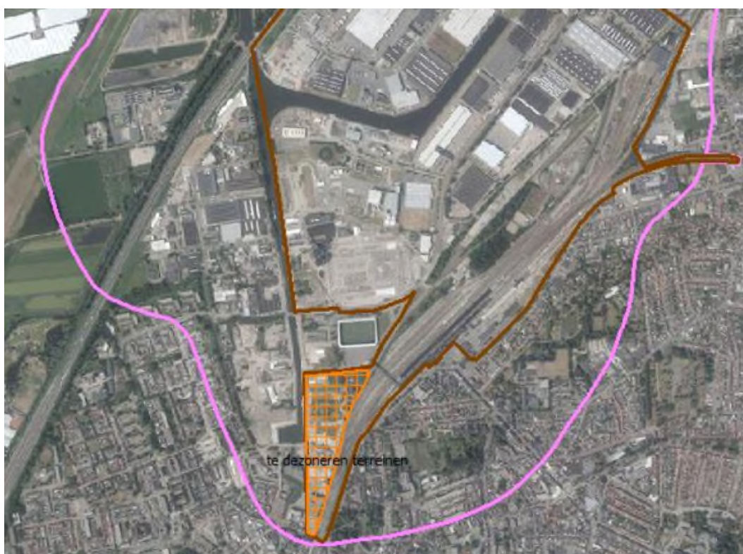
Figuur 2.1: Vastgestelde geluidszone Borchwerf I (bruine lijn: plangrens bedrijventerrein, roze lijn: zone 50 dB(A) contour) (bron: bestemmingsplan Borchwerf I)
