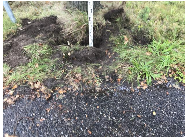
Figuur 26 Profielsleuf bij zomereik aan het noordelijke einde van de Vinkenbroekse baan, ook oude drainagebuis zichtbaar, en proefsluef ten opzichte van wegdek. Wortel slecht zichtbaar op foto door drainagebuis.
