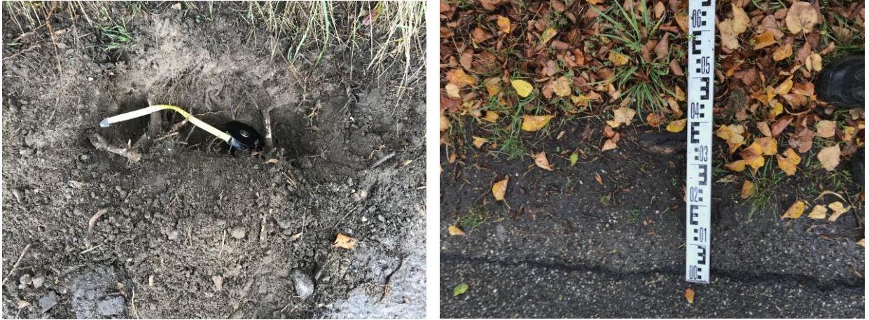
Figuur 17 Foto links: intensieve beworteling vanaf 5 cm -mv, op een afstand van 70 cm vanaf de rand van de rijbaan, bij een es. Foto rechts: oppervlakkige stabiliteitswortel van es op 30-40 cm vanaf de rand van de rijbaan.
