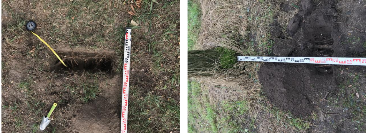
Figuur 23 Foto links: profielsleuf op ca. 4 meter vanaf de rand van het asfalt van Vinkenbroeksestraat en op ca. 1 meter vanaf rand stamvoet van valse acacia, met intensieve fijne beworteling zichtbaar met wortels tot een diameter van 0,5 cm. Foto rechts: intensieve beworteling met stabiliteitswortels tot 4 cm diameter op 1,00 meter vanaf de rand van de stamvoet van een acacia aan het zandpad
