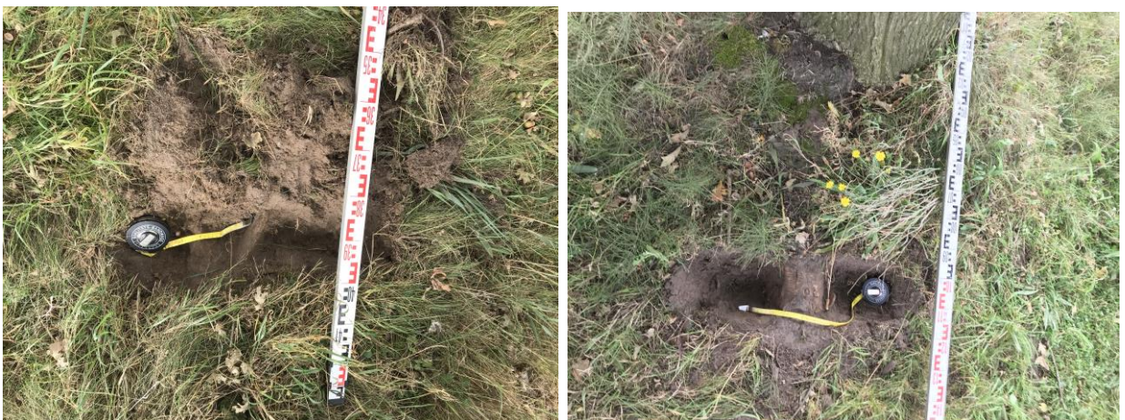
Figuur 5 Profielsleuf met stabiliteitswortels ( \varnothing 10 cm) op 5 cm -mv (links) en stabiliteitswortel ( \varnothing 25 cm) direct onder maaiveld (rechts) op locaties waar ontgravingen nodig zouden zijn.
