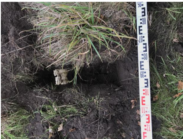
Figuur 26 Profielsleuf bij zomereik aan het noordelijke einde van de Vinkenbroekse baan, ook oude drainagebuis zichtbaar, en proefsluef ten opzichte van wegdek. Wortel slecht zichtbaar op foto door drainagebuis.
