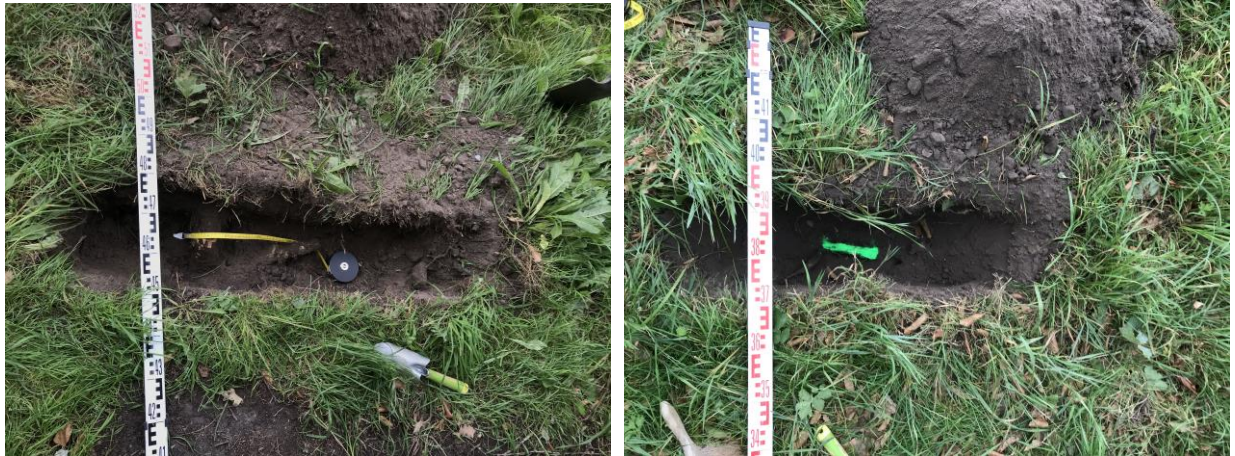
Figuur 9 Sleuven onderaan talud, in de berm richting de sloot, waar ruimte is om het snelfietspad aan te leggen. Met stabiliteitswortel (ø 10 cm) van witte abeel op 10 cm -mv (links) en een boomwortel van beuk (ø 3 cm) op 25 cm -mv.
